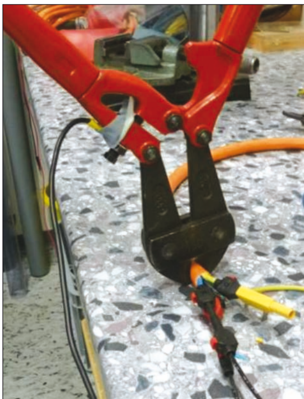
Bild 26: Getestete ungeschirmte Ladeleitung
