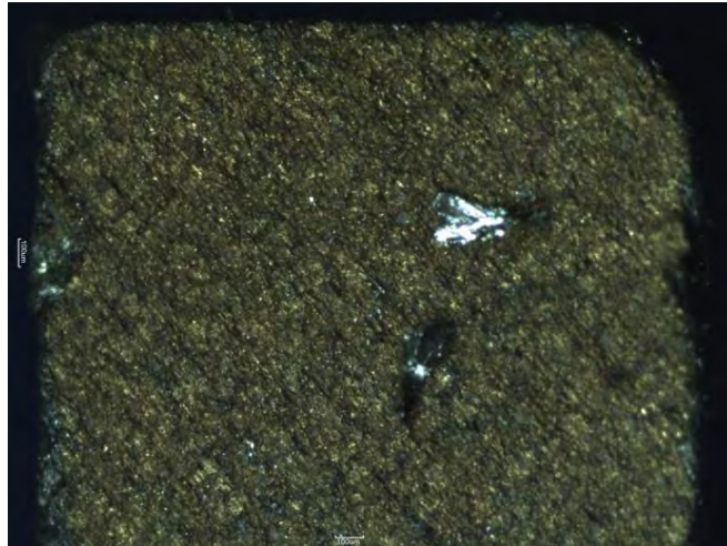
Abbildung 7: Halbleiteroberfläche eines vergoldeten p-dotierten Pellets (Auflichtmikroskop).
