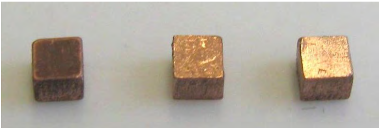
a) nur Gleitgeschliffen, b) nur mit Säure behandelt, c) Gleitgeschliffen, mit Säurebehandelt und mit Glasfaserstift gereinigt.
