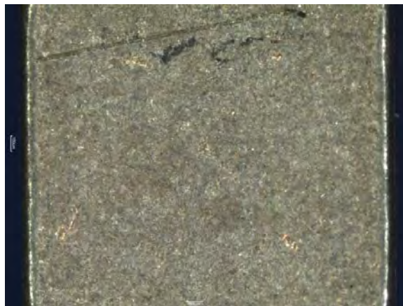
Abbildung 11: Fügefläche eines gleitgeschliffenen Kupferquaders.
