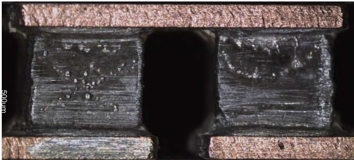
Abbildung 3: Gelöteter Probekörper als Halbleiterschekelpaar
