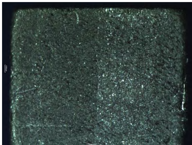
Abbildung 8: Oberfläche eines n-Halbleiterschenkels mit mittiger Bruchkante.
