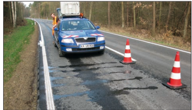
Bild 32: Fahrbahnzustand auf der L 604 eine Stunde nach der Überfahrt mit dem Wasserschleppwagen und dem Streufahrzeug
