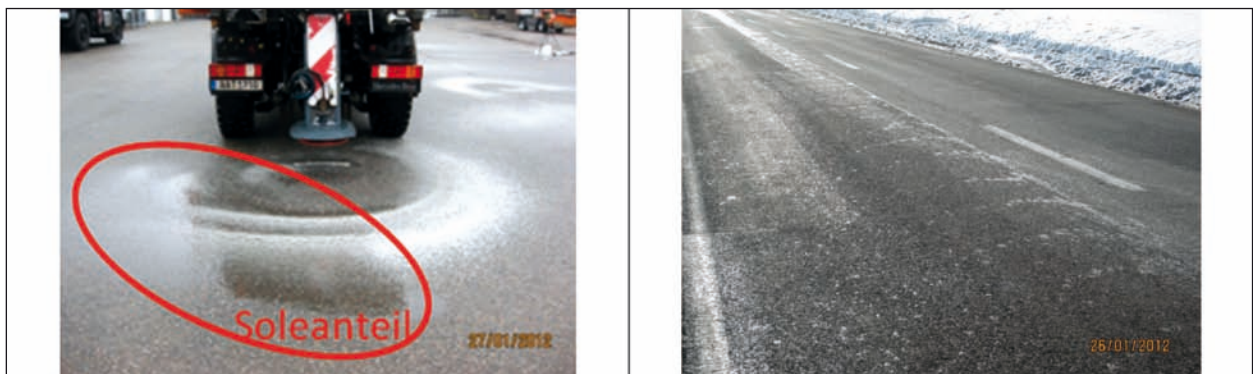
Bild 102: Streuerüberprüfung in KW 10-2012, Schwäbisch Gmünd
