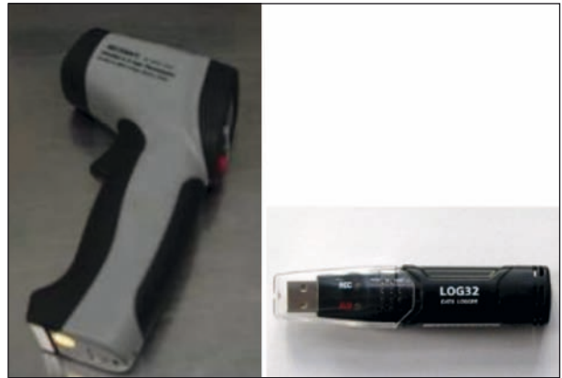
Bild 12: Infrarotthermometer zur Überprüfung der Fahrbahntemperatur (links); Temperaturlogger zur Dokumentation von Lufttemperatur und relativer Luftfeuchte (rechts)
