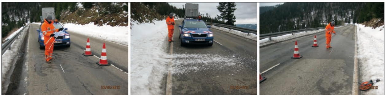
Bild 77: Ablauf der Messflüssigkeit von der Fahrbahn (links), L66b_b, Fahrtrichtung A; Künstliche Anfeuchtung der Fahrbahn mit Schnee (Mitte) und nach 16 Fahrzeugübergängen (rechts), L66b_b, Fahrtrichtung B, Gernsbach
