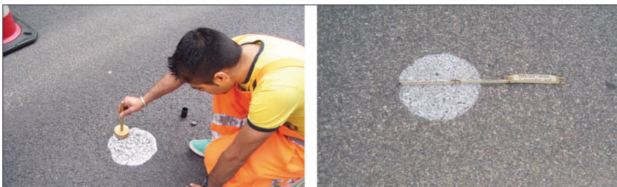
Bild 15: Durchführung des Sandfleckverfahrens
