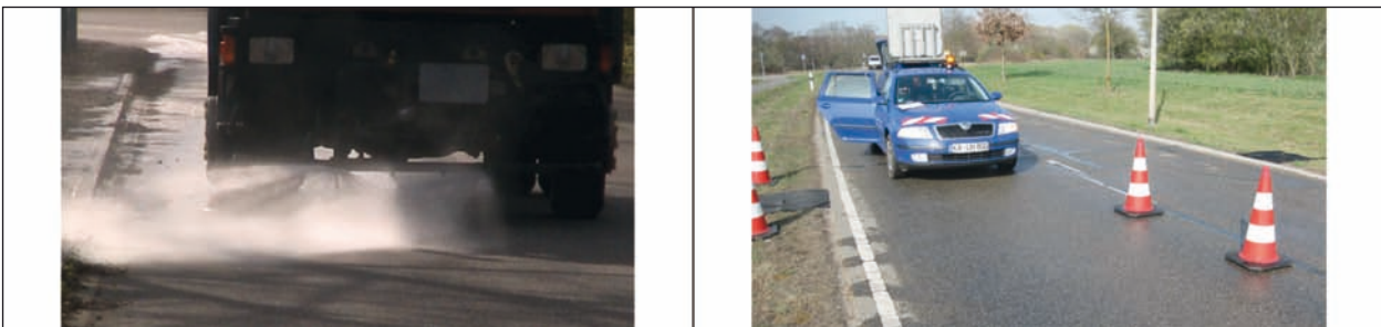
Bild 28: Wasserschleppwagen im Einsatz (links), Fahrbahnzustand nach der Überfahrt mit dem Wasserschleppwagen und dem Streufahrzeug, KW 13-2012, Karlsruhe
