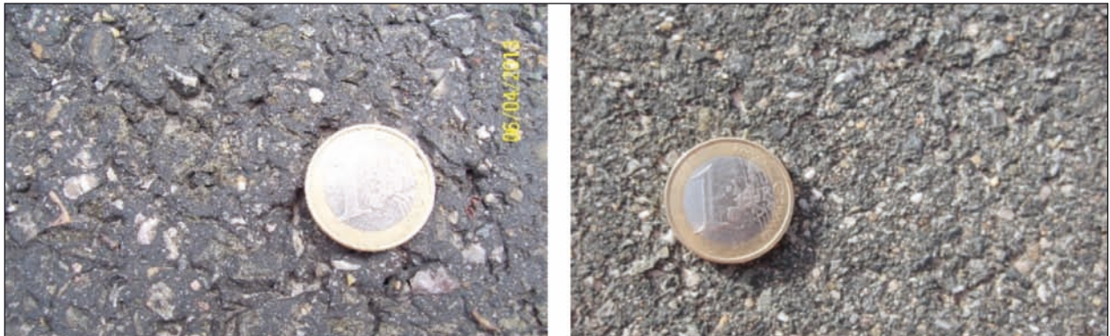
Bild 16: Vergleich der Oberflächentextur; links: MTD = 0,37 mm (L 604, Karlsruhe), rechts: MTD = 0,31 mm (Wü9a, Würzburg)
