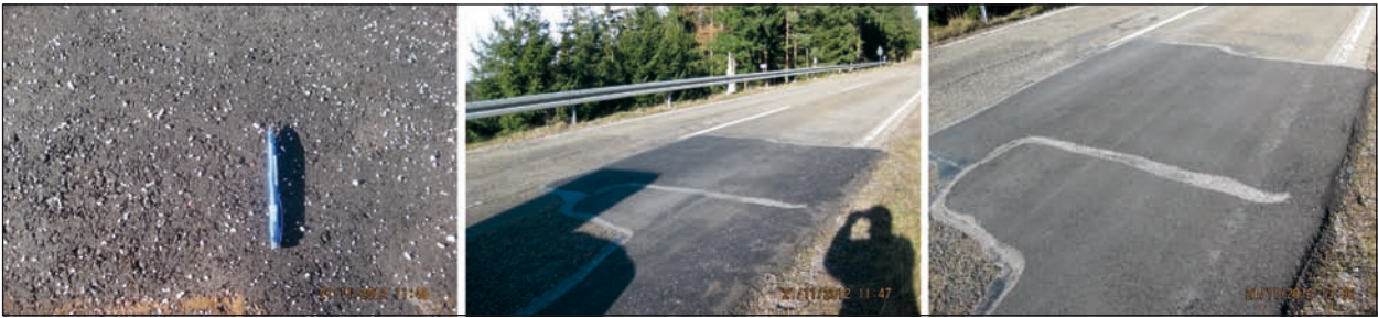
Bild 86: Tausalzverteilung nach ca. 5 Fahrzeugen auf dem Randstreifen (links), auf dem kompletten Fahrstreifen (Mitte) und nach ca. 30 Fahrzeugen auf dem Fahrstreifen (rechts)
