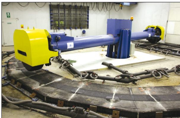
Bild 31: Rundlaufanlage der STUVA
