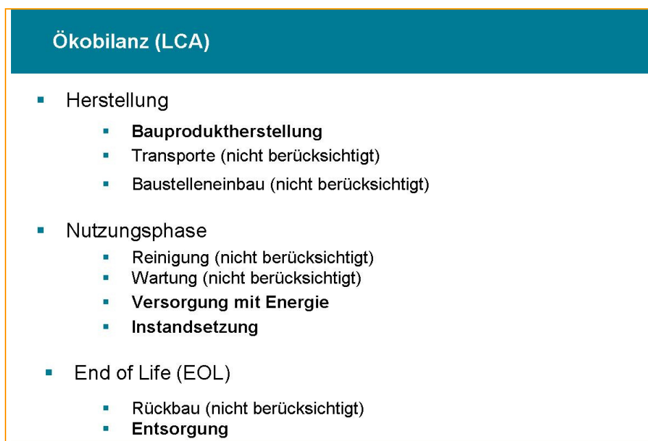
Abb. 8-3: Lebenszyklusphasen für die Ökobilanz eines Gebäudes
