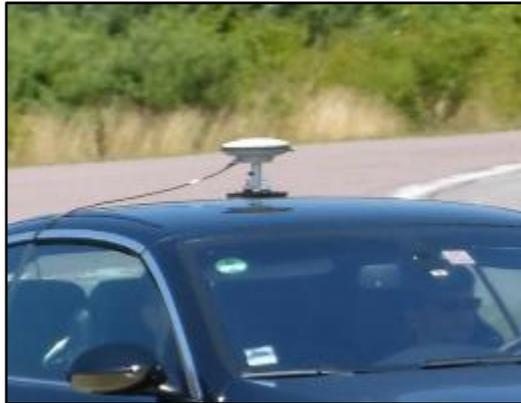
Abbildung 38: Der GPS-Empfänger auf dem Dach des Messfahrzeuges
