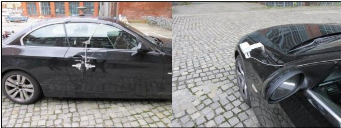
Abbildung 40: Anbauvariante der „Vaisala DSP 211“ Messeinheiten
