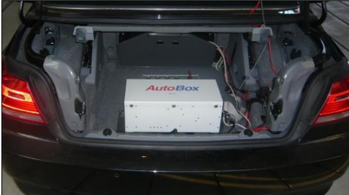
Abbildung 41: Die Autobox von dSpace im Messfahrzeug
