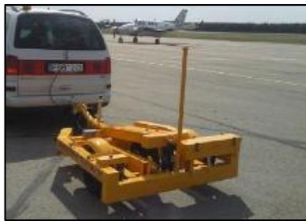
Abbildung 31: Skiddometer BV11 [JSC, 2016]
