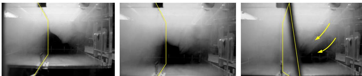
Abbildung 16: Lee-Strömung (Paddleffekt) und erzeugter Überdruck an schwenkendem Drehtisch<sup>2</sup>
