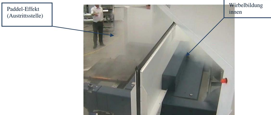
Abbildung 10: Paddel-Effekt und Wirbelbildung an Drehportal
