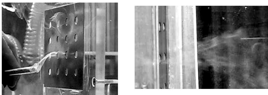
Abbildung 14: Strömungsverlauf der Umgebungsluft in die Kabine
