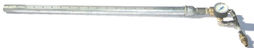
*Abbildung 17: Blasrohr für Versuche „Abreinigung Speicherfilter“*
