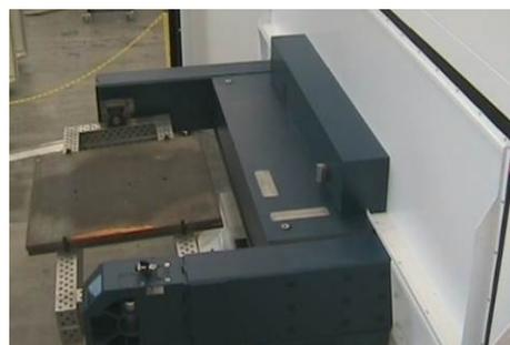
Abbildung 7: Drehtisch der Testkabine
