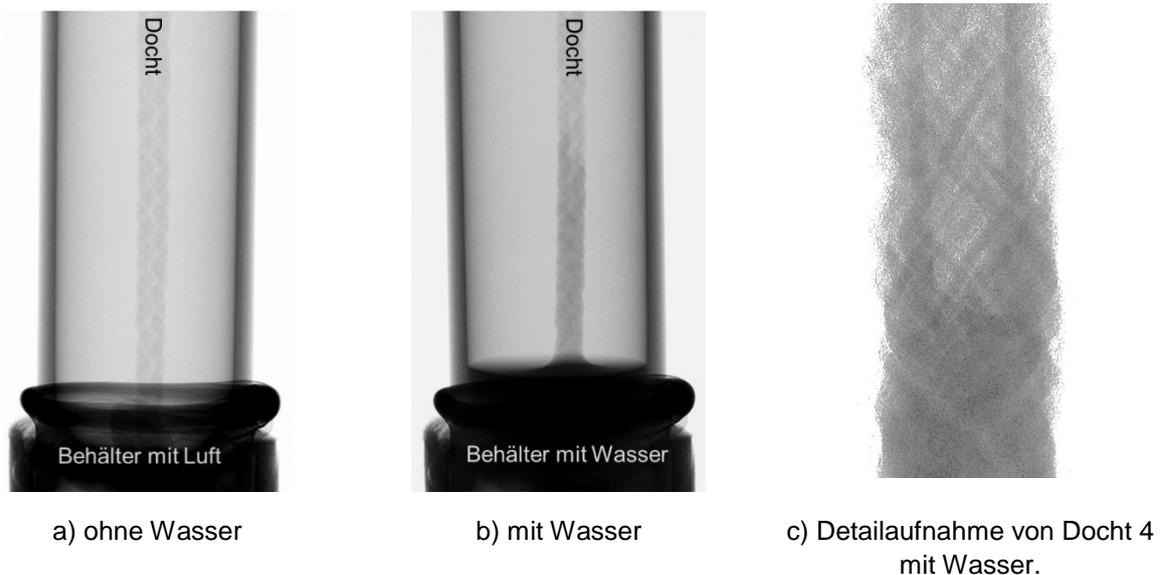
**Abbildung 89: Röntgenbilder von Docht 1 ohne und mit Wasser sowie Detailaufnahme von Docht 4 mit Wasser.**
