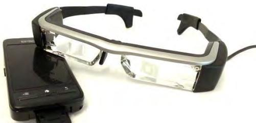
Abbildung 2: HMD (Epson BT-200) als Endgerät für mobile Assistenz. © Alexa Kernchen
