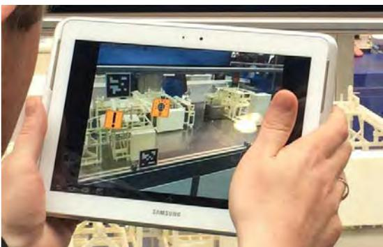
Abbildung 5: Anzeige aufgetretener Fehlerzustände auf den betroffenen Komponenten im Kamerabild. ([6], © Sebastian Möser)
