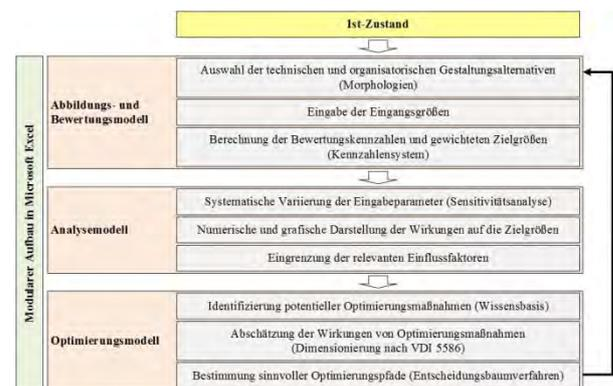
Abbildung 1: Iterativer Lösungsansatz zur Bewertung und Optimierung von Routenzugsystemen (eigene Darstellung)
