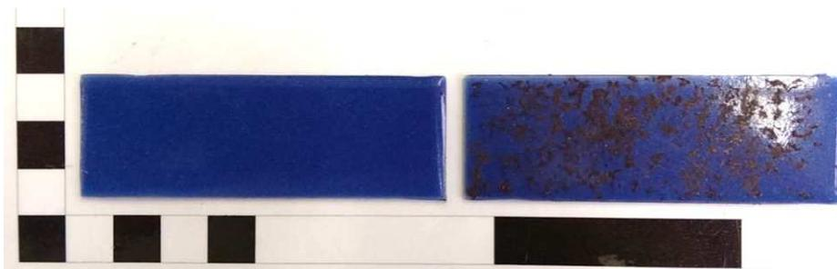
Abbildung 21: Auslagerungspanels SeaLifeHab, rechts: Bewuchs durch Mikro-Algen nach ca. 12 Wochen im Versuchsbecken.
