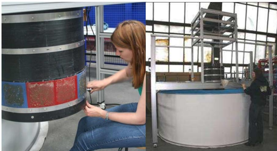
Abbildung 16: Anbringen von gebogenen Testflächen an den Rotationszylinder (links), Absenken des Zylinders ins Wasserbecken zur Dauerbeobachtung (rechts).
