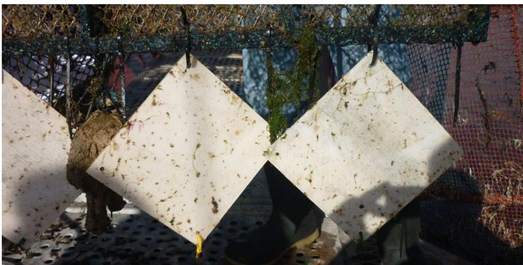
Abbildung 22: Erste Zwischenergebnisse der Bewuchskontrolle der Testflächen, die in Fischfarmen in Chile ausgelagert wurden. Erkennbar weisen die Platten eine sehr niedrige Bewuchsdichte auf.
