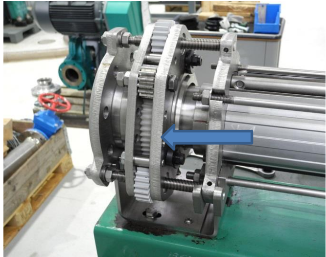
Abbildung 26 Schritt 2 - Lösen der Elastomerverspannung
