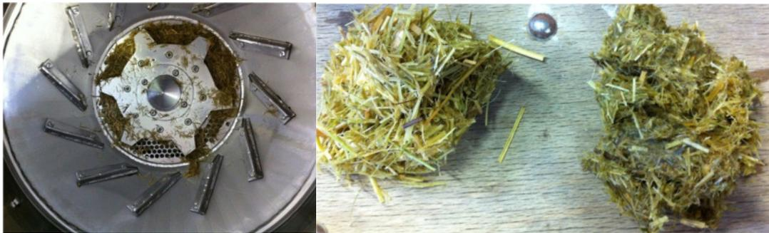
**Abb. 14: Rückstand von Grasbrickets nach 30 min Zerkleinerung im Technikum-Pulper.**
