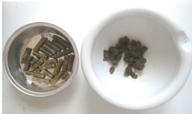
**Abb. 12: Original-Graspellets und Rückstand nach 25 min Desintegration**
