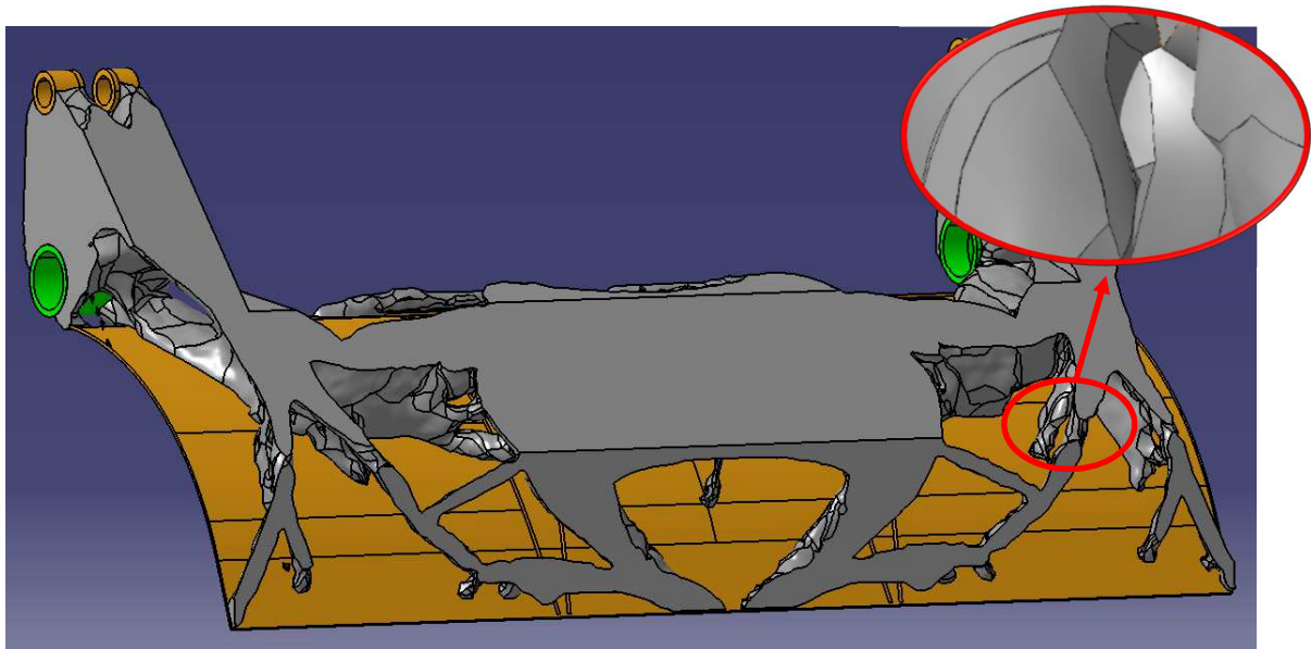
Abbildung 5-17: Geglättete Oberflächendaten aus einer Topologieoptimierung
