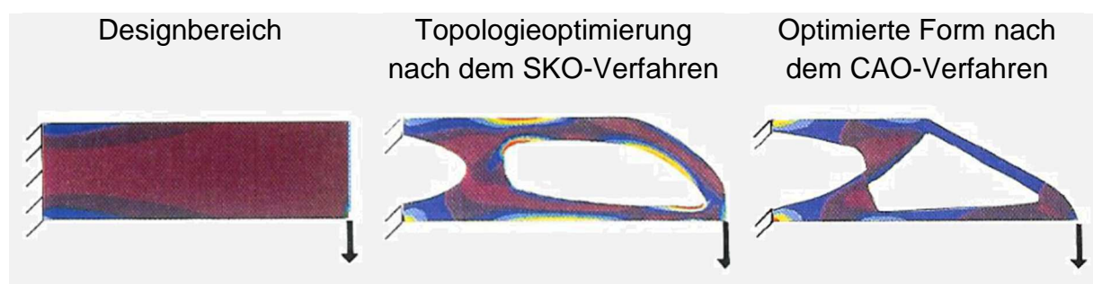
Abbildung 5-26: Formoptimierung nach dem CAO-Verfahren [20]
