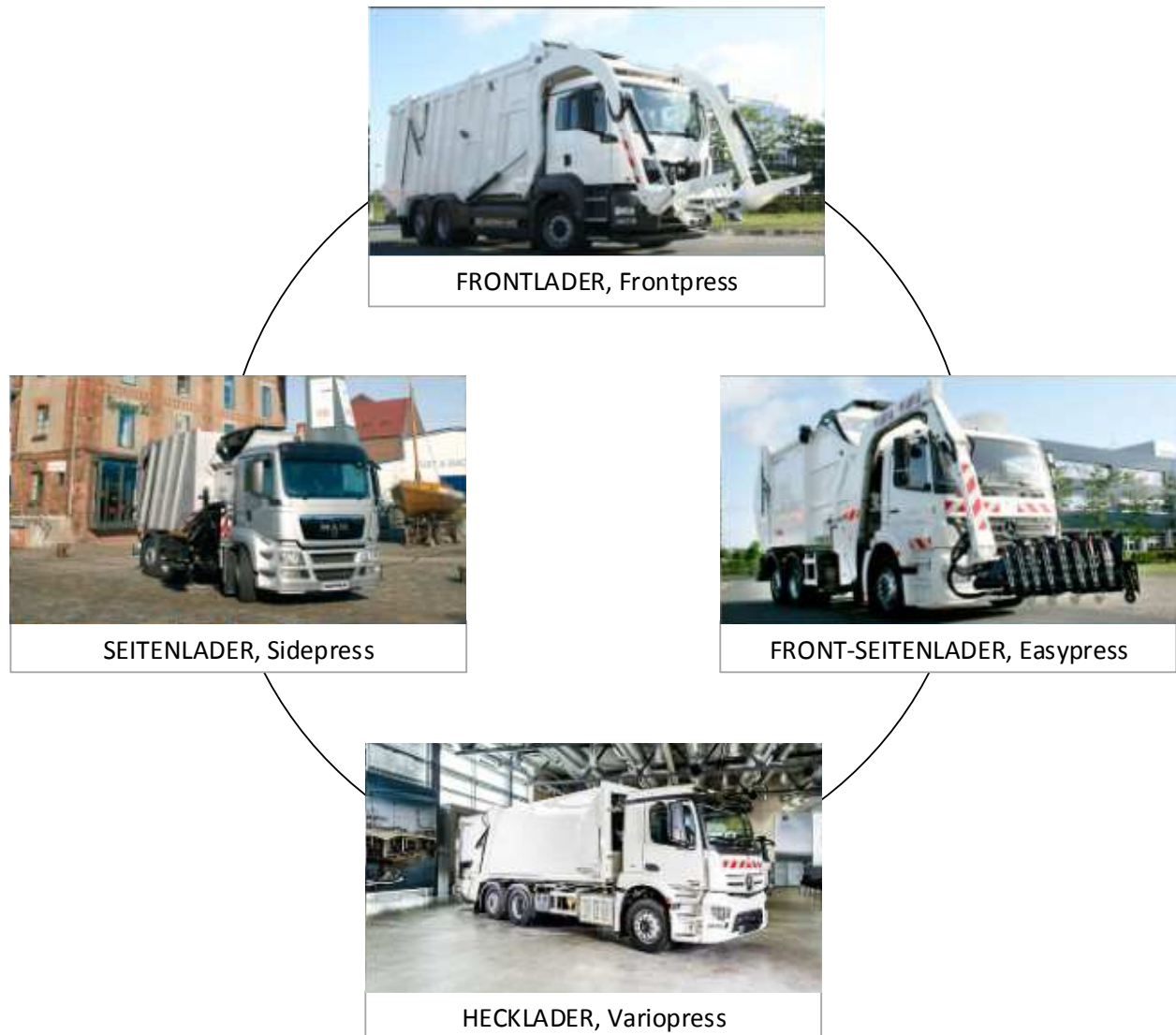
Abbildung 6-1: Bauarten von Abfallsammelfahrzeugen [5]
