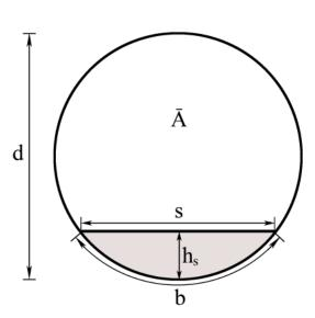
Abbildung 32: Rohrquerschnitt bei Ablagerungen
