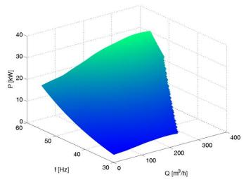
Abbildung 31: Leistungsaufnahmekennfeld der Pumpe in Prerow
