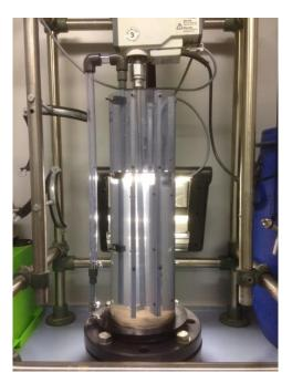
Abbildung 10: Erosionszylinder Uni Rostock
