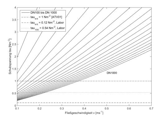
Abbildung 30 Schubspannungen differenzierter DN gegen die Fließgeschwindigkeit
