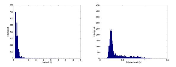
Abbildung 25: Histogramm über Lauf- und Stillstandzeiten bei energieoptimaler Steuerung
