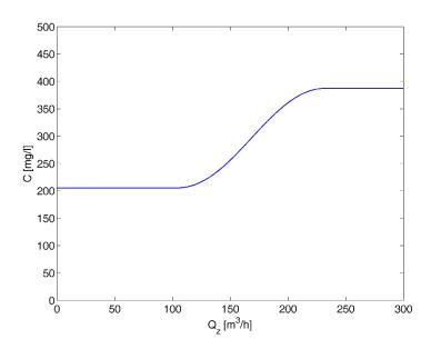
Abbildung 23: Feststoffkonzentration in Abhängigkeit vom Abwasserzulauf während eines Pumpzyklusses
