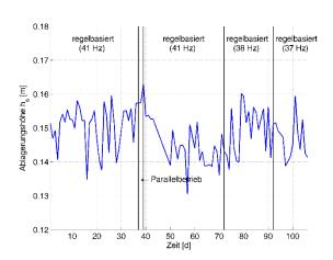
Abbildung 33: Verlauf der Ablagerungshöhe in Druckleitung Rostock/Schmarl
