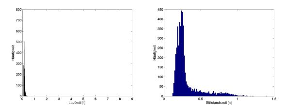
Abbildung 24: Histogramm über Lauf- und Stillstandzeiten bei Zweipunktsteuerung
