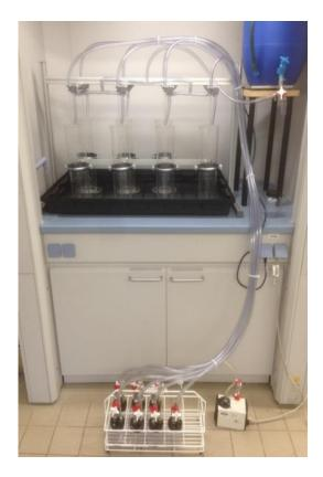
Abbildung 1: Sedimentationsapparat Uni Rostock
