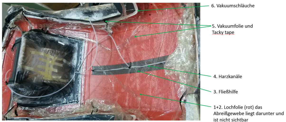
Abbildung 31: Vakuuminfusionsaufbau am Beispiel Monocoque Oberteil
