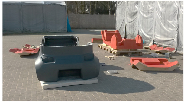
Abbildung 28: Links: Montiertes GFR-Werkzeuge; Rechts Werkzeugteile und entformtes Bauteil
