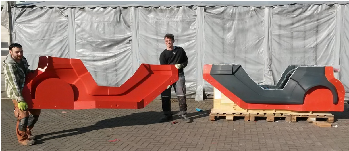
Abbildung 24: GFK-Werkzeugsegment Monocoque-Seitenteil unten rechts
