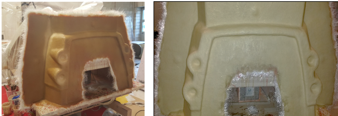
Abbildung 23: Frisch laminiertes WKZ-Segment (re.) und das voll ausgehärtete Element (li.)
