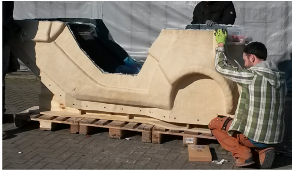
Abbildung 28: Links: Montiertes GFR-Werkzeuge; Rechts Werkzeugteile und entformtes Bauteil
