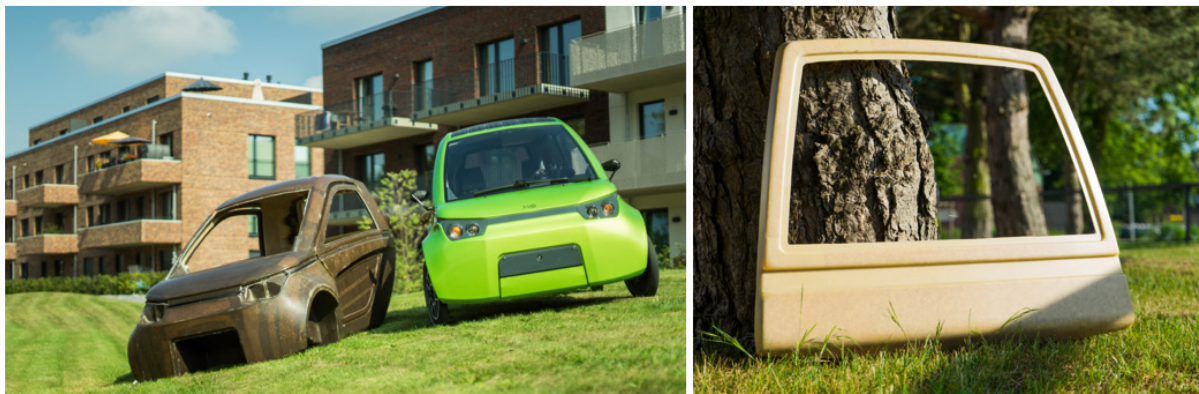
Abbildung 35: Links: Monocoque in NFK-Bauweise, Rechts: NFK-Heckklappe
