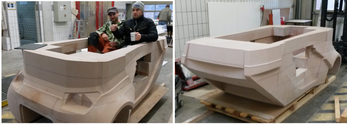
Abbildung 17: Gefräste Positivform Monocoque Unterteil inkl. Probesitzen
