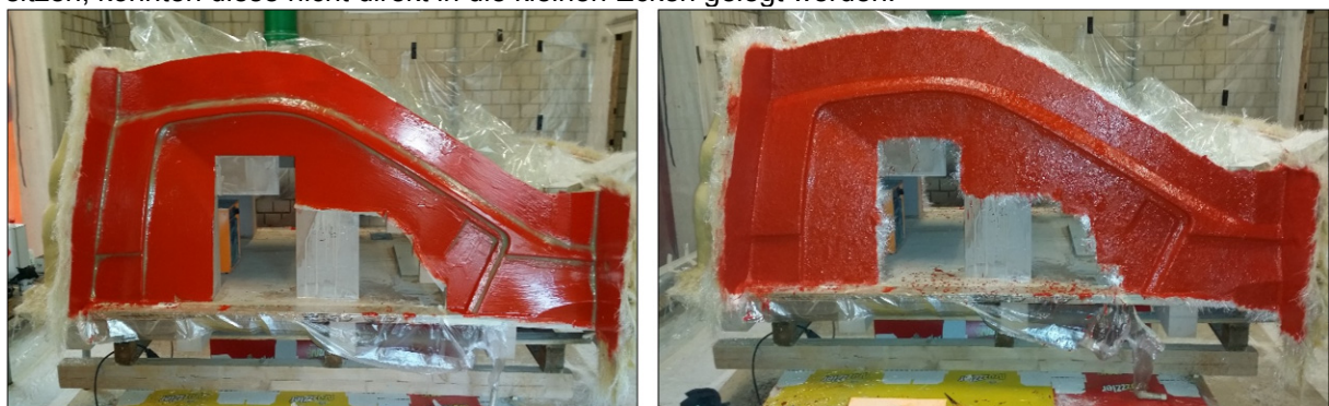
Abbildung 21: Erste Gelcoat-Schicht (li.) mit erster Laminatschicht (re.)
