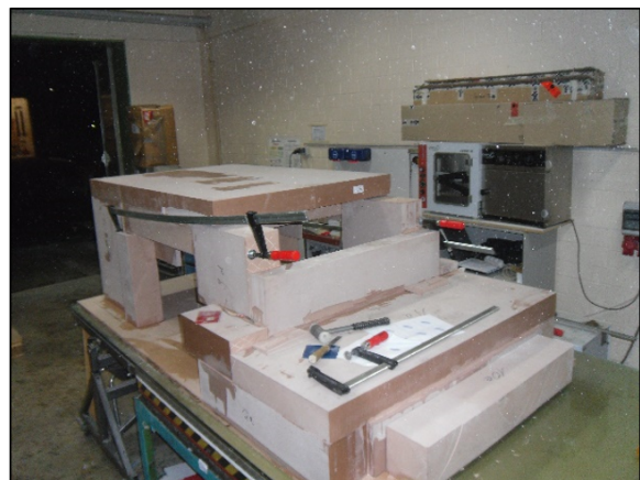
Abbildung 16: Schrittweise Aufbau und Verklebung des Fräsrohlings aus PU-Kunststoffblöcken
