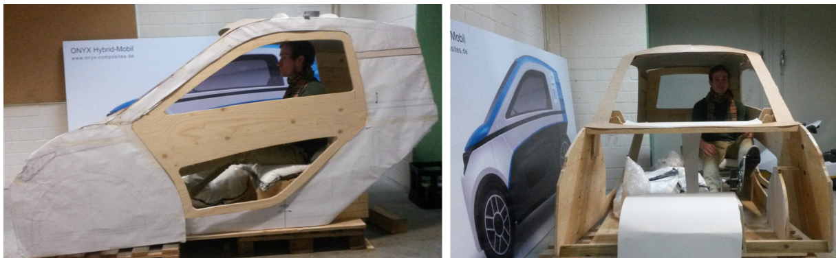
Abbildung 12: Funktions- und Ergonomiekontrollmodell in Holzbauweise (Format 1:1)
