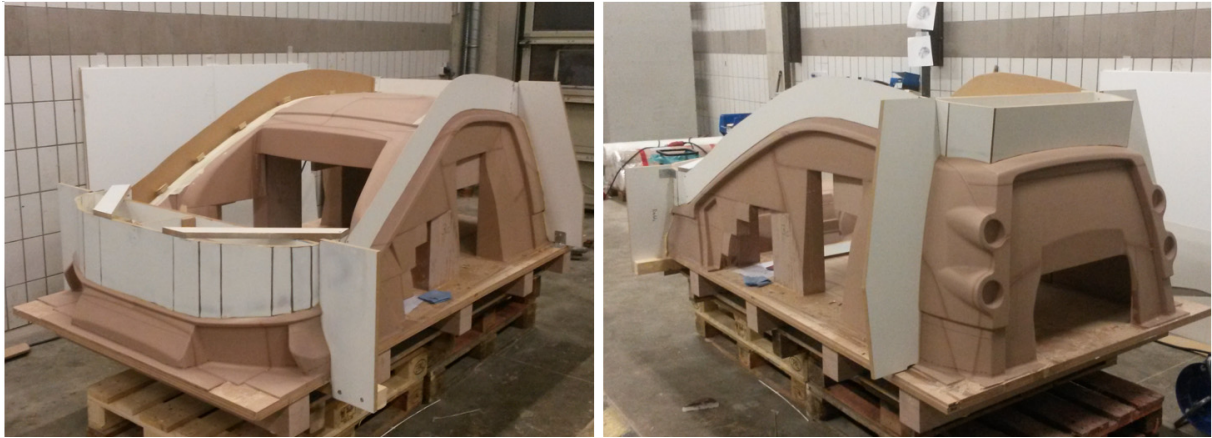
Abbildung 19: Darstellung des Trennebenenaubaus am Bsp. Monocoque-Oberteil
