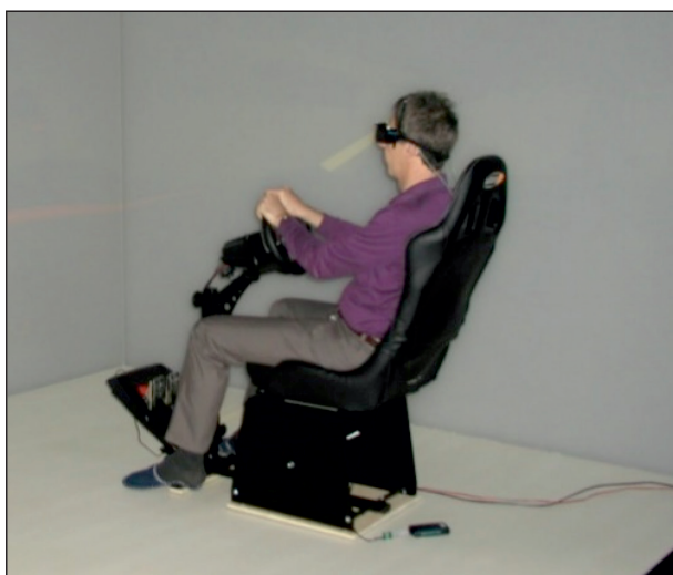
Bild 2: Bedienelemente der Fahrsimulation; Lenkrad und Gas- sowie Bremspedal in der CAVE
