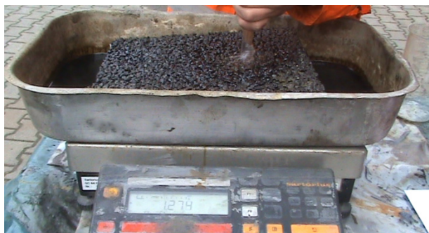
Bild 47: Kleinversuch zur Abschätzung des Verdunstungseffektes
