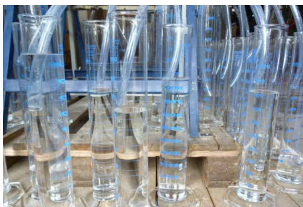
Bild 25: Ableitung der Flüssigkeit über PVC-Schläuche in skalierte Messzylinder
