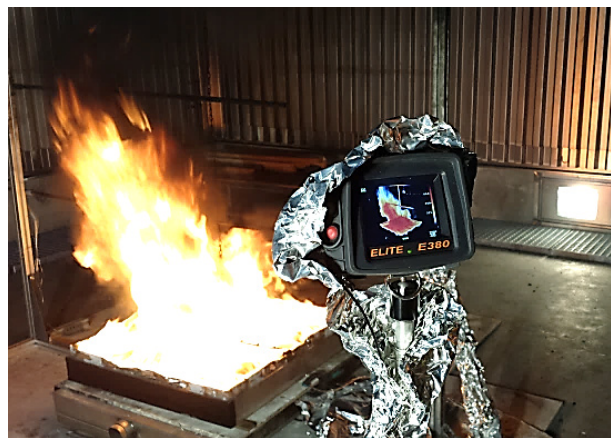
Bild 57: Einsatz der Wärmebildkamera
