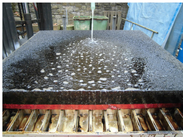
Bild 33: Schneller oberflächlicher Abfluss bei der SMA-Variante mit 6,0 % Neigung
