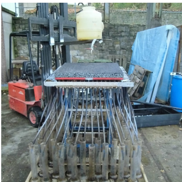
Bild 29: Gesamtversuchsanordnung mit Aufgabesystem (hier: SMA-Variante mit 6,0 % Neigung)
