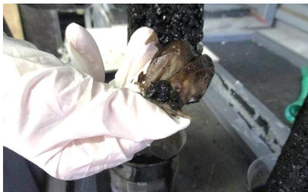
Bild 21: Zerfall des PA-Probekörpers nach kurzer Lagerung in Benzin
