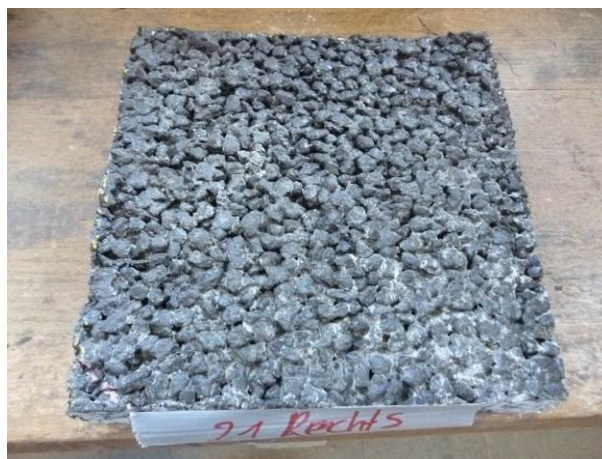
Bild 14: Ausbaustück (exemplarisch) zur Bestimmung des Hohlraumgehalts
