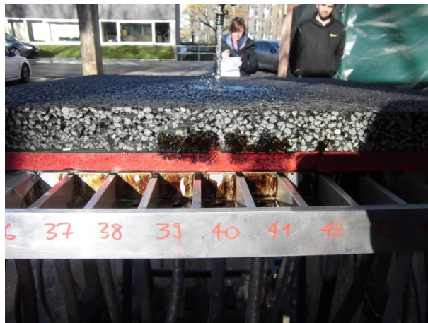
Bild 38: Beginnender Flüssigkeitsaustritt an der Plattenhinterseite (Variante PA 2; V = 26 Vol.-%; s = 6,0 %)
