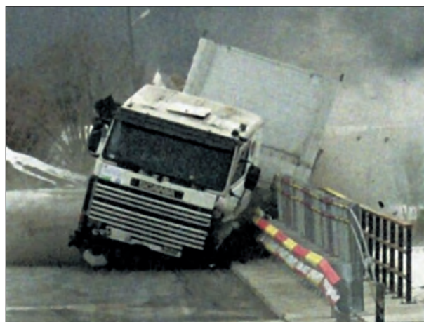
Bild 41: Anprall TB 81 an das System E
