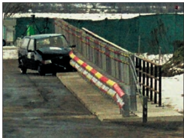
Bild 39: Anprall TB 11 an das System E
