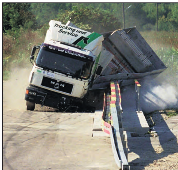
Bild 26: Anprall TB 81 an das System B
