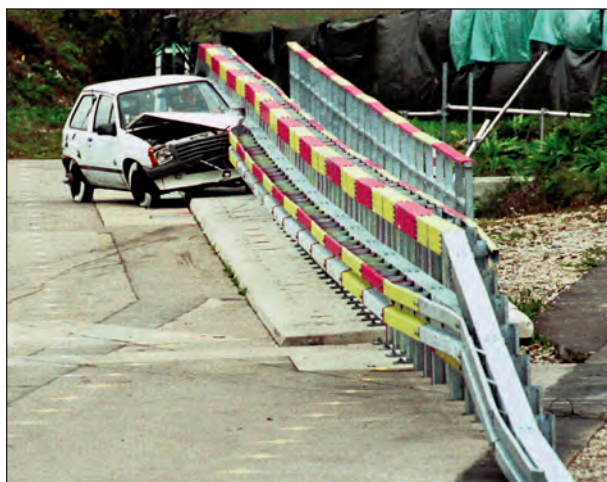
Bild 24: Anprall TB 11 an das System B
