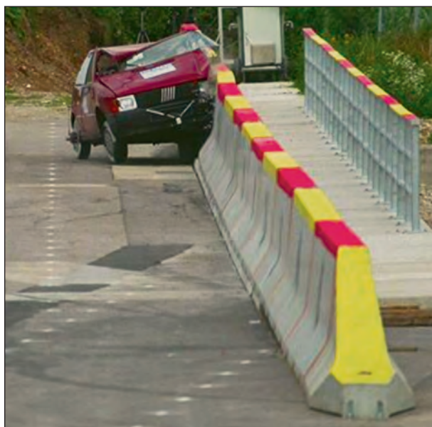
Bild 19: Anprall TB 11 an das System A
