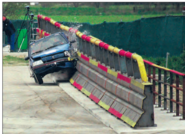
Bild 44: Anprall TB 11 an das System F
