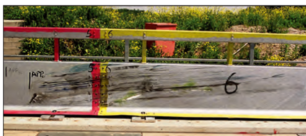
Bild 35: System D: Kontaktstrecke nach Prüfung TB 11 mit Systemschäden
