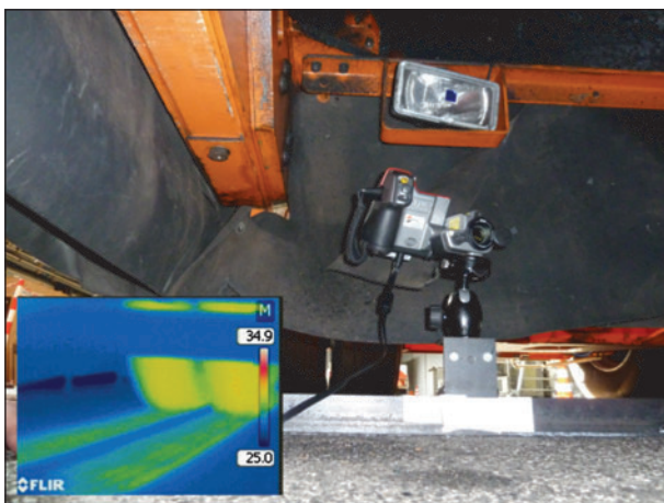
Bild 3-8: Position – Infrarotkamera (IR) auf Räder vorne
