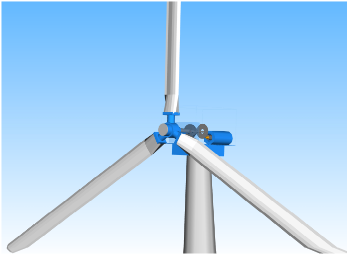
Abbildung 2: Mehrkörpersimulationsmodell der Versuchs-WEA
