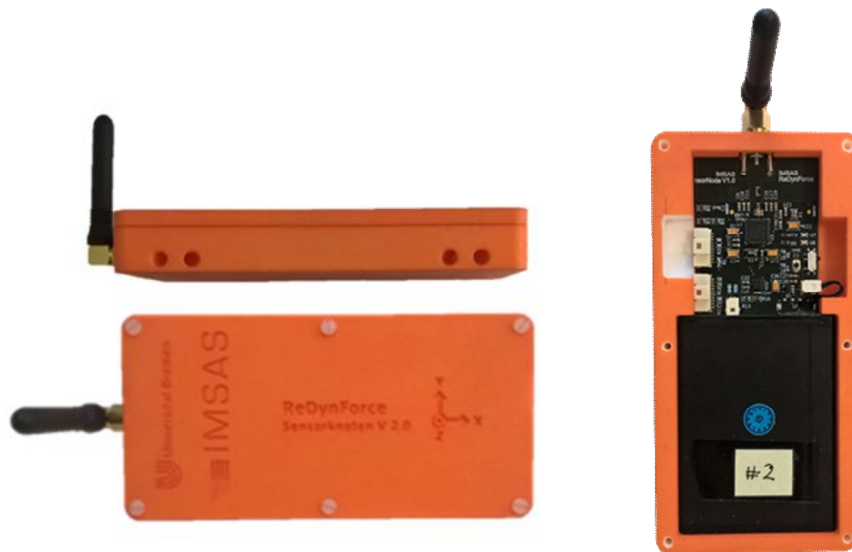
Abbildung 11 - Gehäuse drahtloser Sensorknoten
