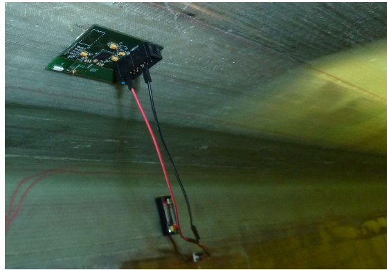
Abbildung 9 - Evaluation der Funkmodule in einem 86m langen Offshore Rotorblatt
