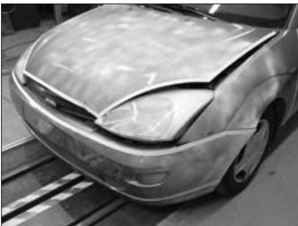
Bild 6.7: Vollfahrzeug Ford-Focus-Front (Versuchsnummer 36) nach Versuch mit Beschädigungen
