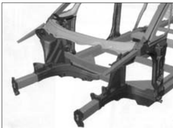
Bild 4.3: Vorbau Audi A2 (Modell ab 1999) mit Strangpressprofilen als Längsträgerelemente, dahinter liegend: Gussknoten, aus LEITERMANN et al. (1999) [37]
