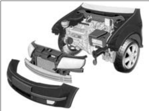
Bild 4.8: Vorderwagen Skoda Fabia mit Frontmodul und davor liegender Außenhaut, nach BOCKELMANN et al. (2000) [9]
