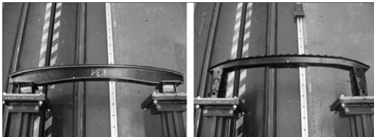
Bild 7.23: Frontquerträgerstruktur Ford Focus, links: Modell 1998 bis 2004, rechts: Modell ab 2004
