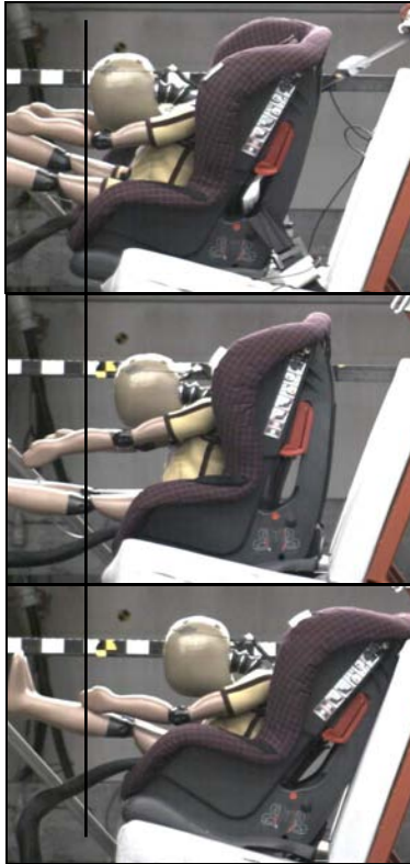
Bild 141: Vergleich der maximalen Vorverlagerung bezogen auf das gegurtete KSS (von oben: KSS gegurtet, ISOFIX, ISOFIX mit Top-Tether) nach [SCHULTZ, 2006]
