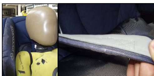
Bild 123: Beschädigung der Dummykleidung (links) durch gummierte Gurtpolster (rechts) (KSS M)
