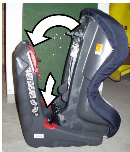
Bild 87: KSS mit Automatischer Gurtstraffung bei dem Zusammenklappen des KSS
