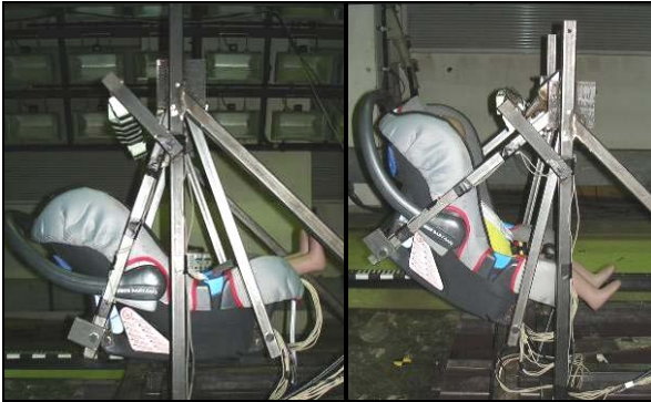
Bild 140: Anfangs- und Endstellung des Drehsitzes
