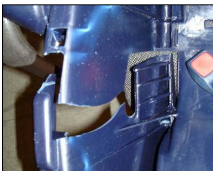
Bild 120: Gebrochene Babyschale A bei TUB-SIPCRS
