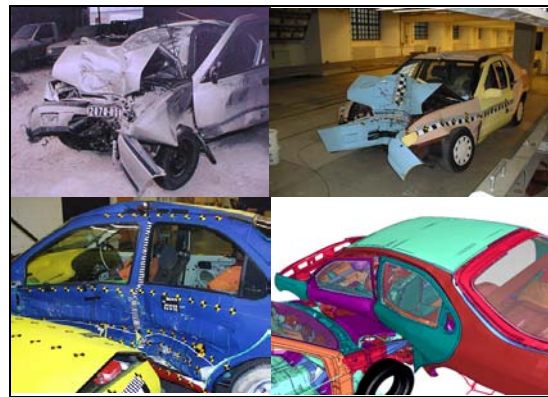
Bild 137: Möglichkeiten der Unfallanalyse; Oben links: Realunfall, rechts: Laborversuch; unten links: Laborversuch, rechts: Simulation
