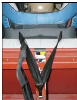
Bild 142: Top-Tether an normalem KSS [SCHULTZ, 2006]
