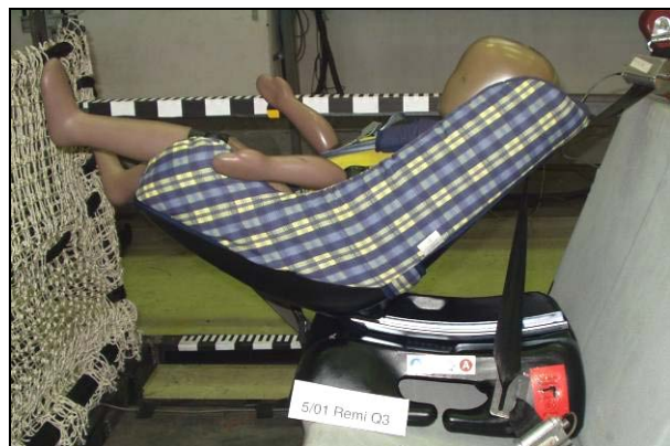
Bild 119: Endstellung durch gebrochene Sitzschiene bei HighSpeed (KSS N)
