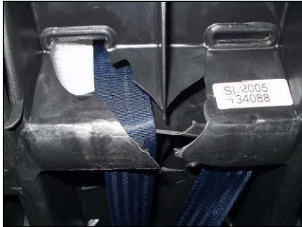
Bild 116: Gebrochene Gurtführung bei ADAC-Frontal (KSS F)
