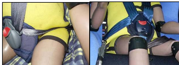
Bild 122: Gurteindringung (links) und hohes Gurtschloss (rechts) durch schlechte Gurtführung (KSS F)
