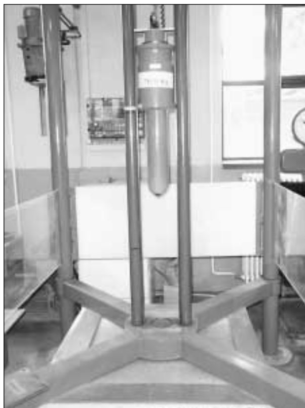
Bild 5: Gerät zur Prüfung des Durchschlagwiderstandes der GTD
