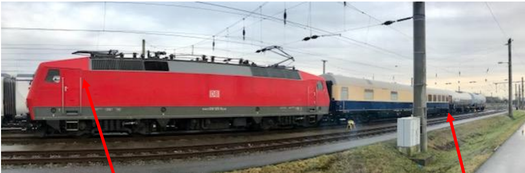
Abbildung C-2: Messkonfiguration Lok + Messwagen + 1. Güterwagen + 2. Güterwagen
