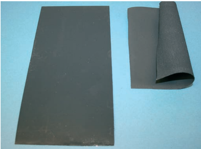
Abb. 2: starre (links) und flexible (rechts) Gasdiffusions-Elektrode (Covestro Deutschland AG)
