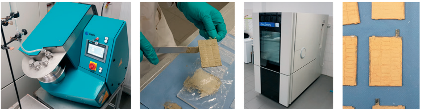
Abb. 2: Übersicht über die einzelnen Schritte der Elektrodenpräparation, v.l.n.r.: Labormischer, Pastierung eines Elektrodengitters, Reifekammer, fertige Elektrode ©PENOX GmbH
