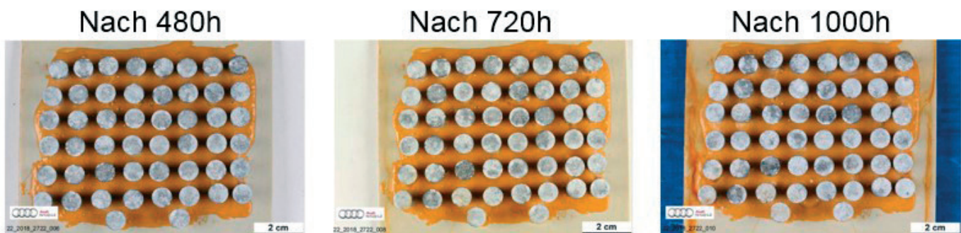
Abb. 4: Ergebnis Salzsprühnebeltest 36 AlCr-Multilagen Beschichtung [©Audi], M. Neubauer
