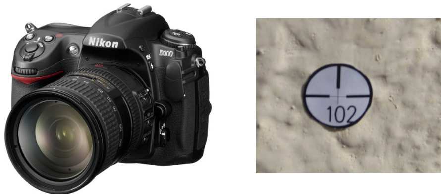
Abbildung 13: Aufnahmekamera, verwendete Zielmarken am Aufmaßobjekt
