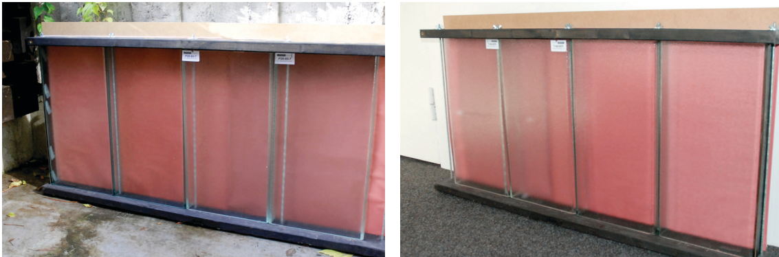
Abb. 21 Testelemente Profilglas und farbige Beschichtung
