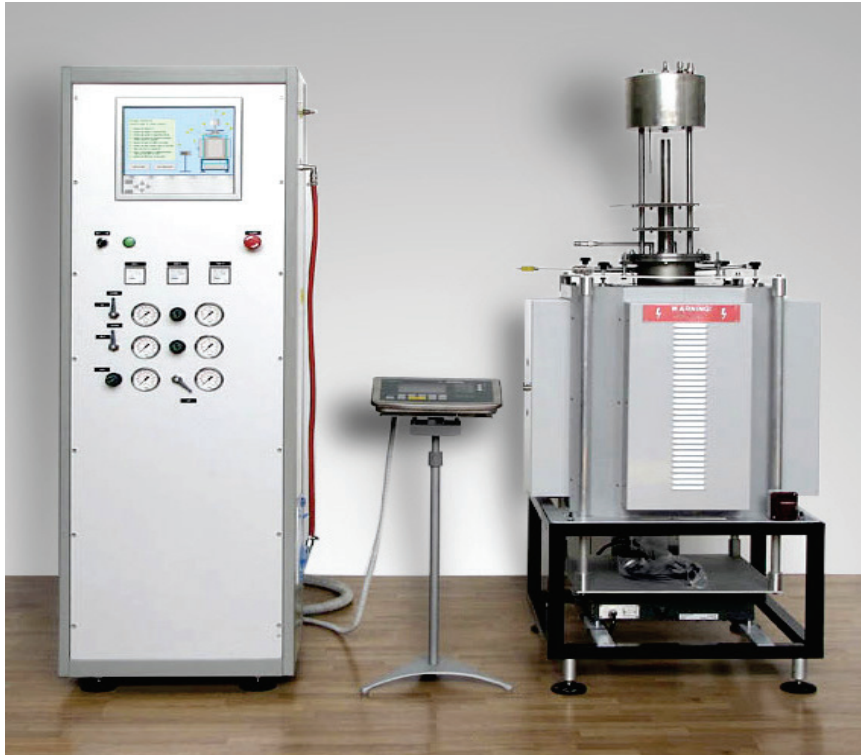
Bild 6: Messeinrichtung für den RUL-Test
