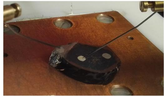
Abb. 39: I/U-Kennlinie einer CSS-Zelle mit n-dotiertem AZO-layer (2%Al). Eine leicht sperrende Kennlinienform ist erkennbar. Eine einschaltbare Beleuchtung war durch die Mikroskopbeleuchtung am 2-Spitzenmessplatz gegeben. Rechts sind die Kontaktierungspunkte auf der n-ZnO-Schicht und den Al-Kontakt zum p-dotierten CSS-Silizium.
