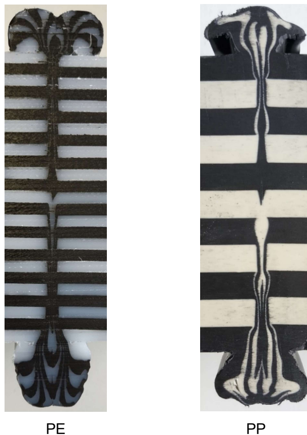
Bild 79: Visualisierung des Quetschflusses bei Plattenverbunden mit einer Wanddicke von 100 mm (PE) und 66 mm (PP)
