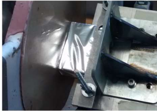
Bild 16: Abschirmung der Seiteneinstrahlung des Heizelements mittels Aluminiumfolie
