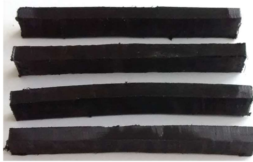
Bild 59: PE-Proben nach dem Schlagbiegeversuch mit einem Pendelhammer mit 25 J Arbeitsvermögen
