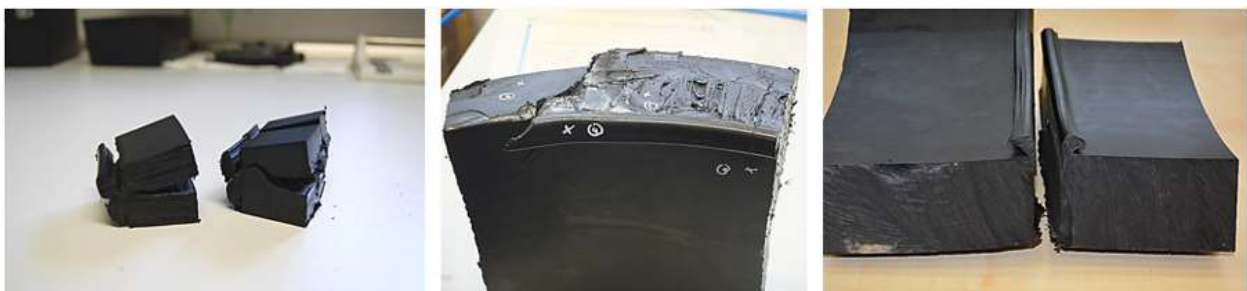
Bild 1: Schlagartiges, sprödes Bruchverhalten von PE100 RC (heizelementstumpfgeschweißt nach DVS 2207-1) bei Verlegearbeiten; Wanddicke: 35 mm (links), 60 mm (Mitte) und 75 mm (rechts)
