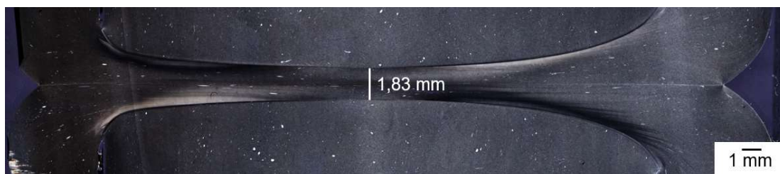
Bild 46: Messposition zur Ermittlung der Restschmelzeschichtdicke (Beispiel: PE100 RC, 30 mm Wanddicke)
