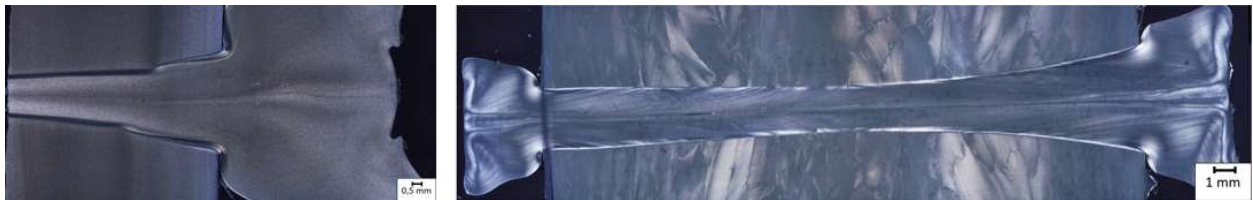
Bild 67: Mikroskopieaufnahmen von Schweißnähten aus PP-H; links: Wanddicke 50 mm, extrudiert; rechts: Wanddicke 30 mm, gepresst
