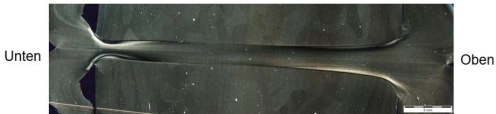
Bild 75: Eliminierung der Schweißnahtkrümmung im unteren Randbereich einer Schweißnaht aus PE100 mit einer Wanddicke von 30 mm
