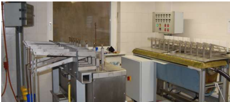
Bild 32: Prüfanlagen zur Durchführung der Zeitstand-Zugprüfungen
