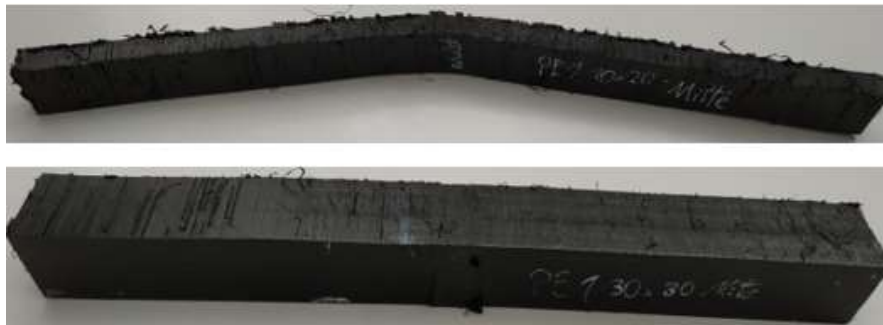
Bild 60: PE-Proben nach dem Schlagbiegeversuch mit einem Schlagpendel mit 150 J Arbeitsvermögen
