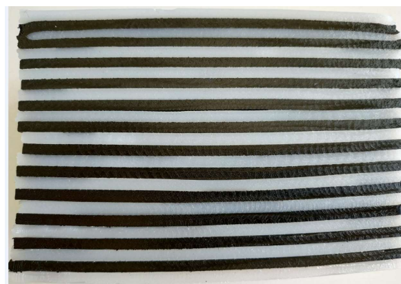
Bild 22: Plattenverbund aus Polyethylen zur Visualisierung des Schmelzefflusses
