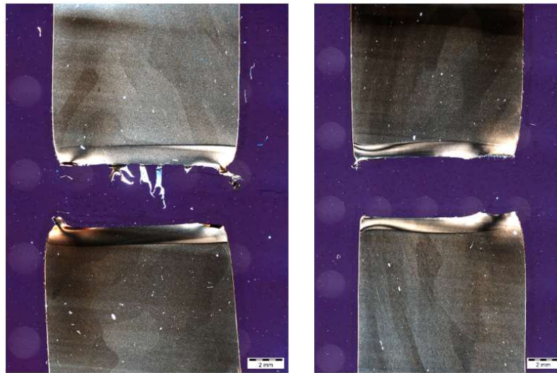
Bild 77: Bruchbilder einer Schweißnaht mit einseitig reduzierter Krümmung nach der Prüfung im Zeitstand-Zugversuch; links: Mitte der Schweißnaht; rechts: Unterer Rand der Schweißnaht
