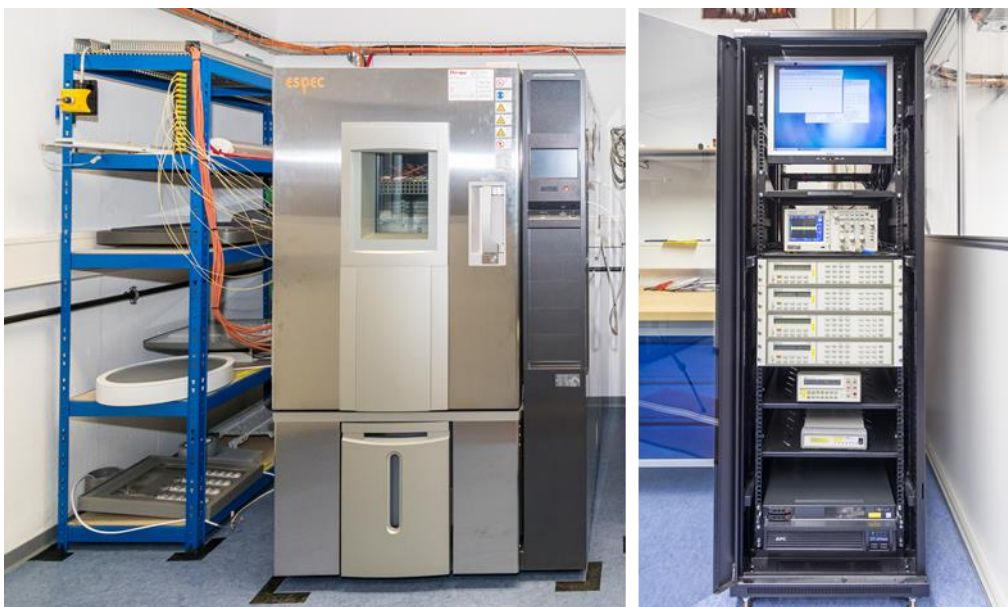
Abbildung 3.2: Fotos des Messaufbaus am Fachgebiet IES. Links: ein Klimaschrank mit LED-Lasten im Regal. Rechts: Laborrechner mit Messtechnik.
