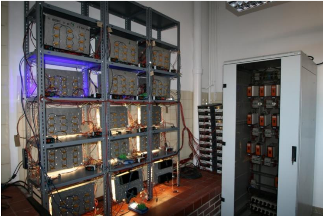
Abbildung 2.3: Alterungsaufbau an der TU Darmstadt
