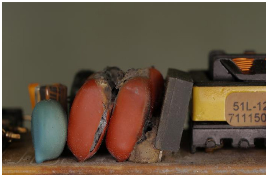
Abbildung 3.5: Aufgebrochene und geschmolzene Filmkondensatoren rechts neben dem Diodengleichrichter.
