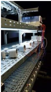
Abbildung 4.1: Alterungsstrecken des VDE Lichtlabors für LED-Innenraumbeleuchtung (links) und LED-Außenbeleuchtung (rechts)
