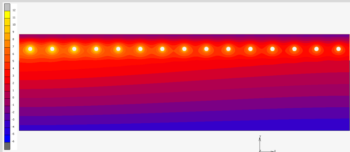
Abbildung 16: Temperaturverteilung (Steady State) am Gesamtsystem im 2. Iterationsschritt (unter Berücksichtigung der Interaktion zwischen den benachbarten Rohren)
