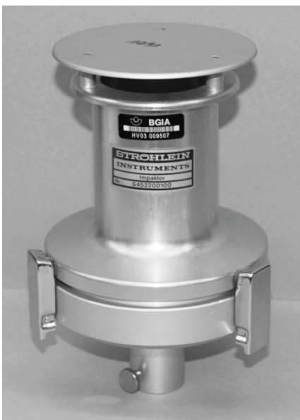
Abbildung 2.4: A-Staub-Probennahmekopf mit Impaktor für das VC-25; Filterdurchmesser: 150 mm [62]
