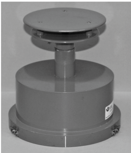
Abbildung 2.3: A-Staub-Probennahmekopf für das VC-25; Filterdurchmesser: 150 mm [62]
