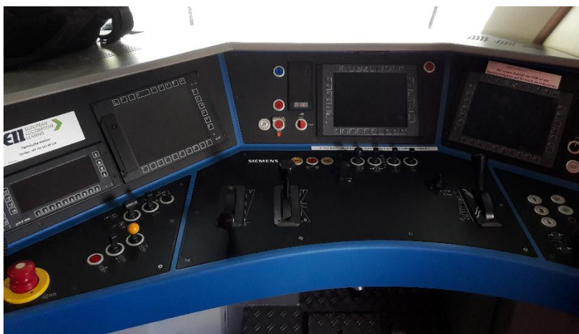
Abbildung 74: Triebfahrzeug-Führerraum einer Drehstromlokomotive der BR 193 (Siemens Vectron) (eigene Darstellung)
