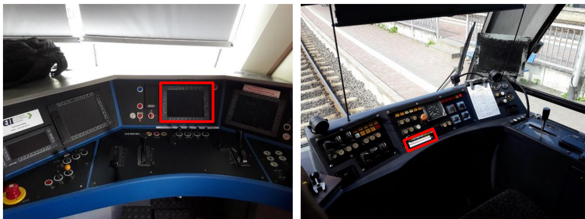
Abbildung 55: Fahrzeugtechnische Integration von PZB-LM (MFD: linkes Bild in Rot – MFA: rechtes Bild in Rot) (eigene Darstellung)
