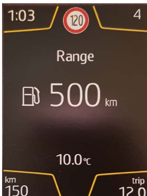
Abbildung 60: Verkehrszeichenerkennung im Armaturenbrett [68]
