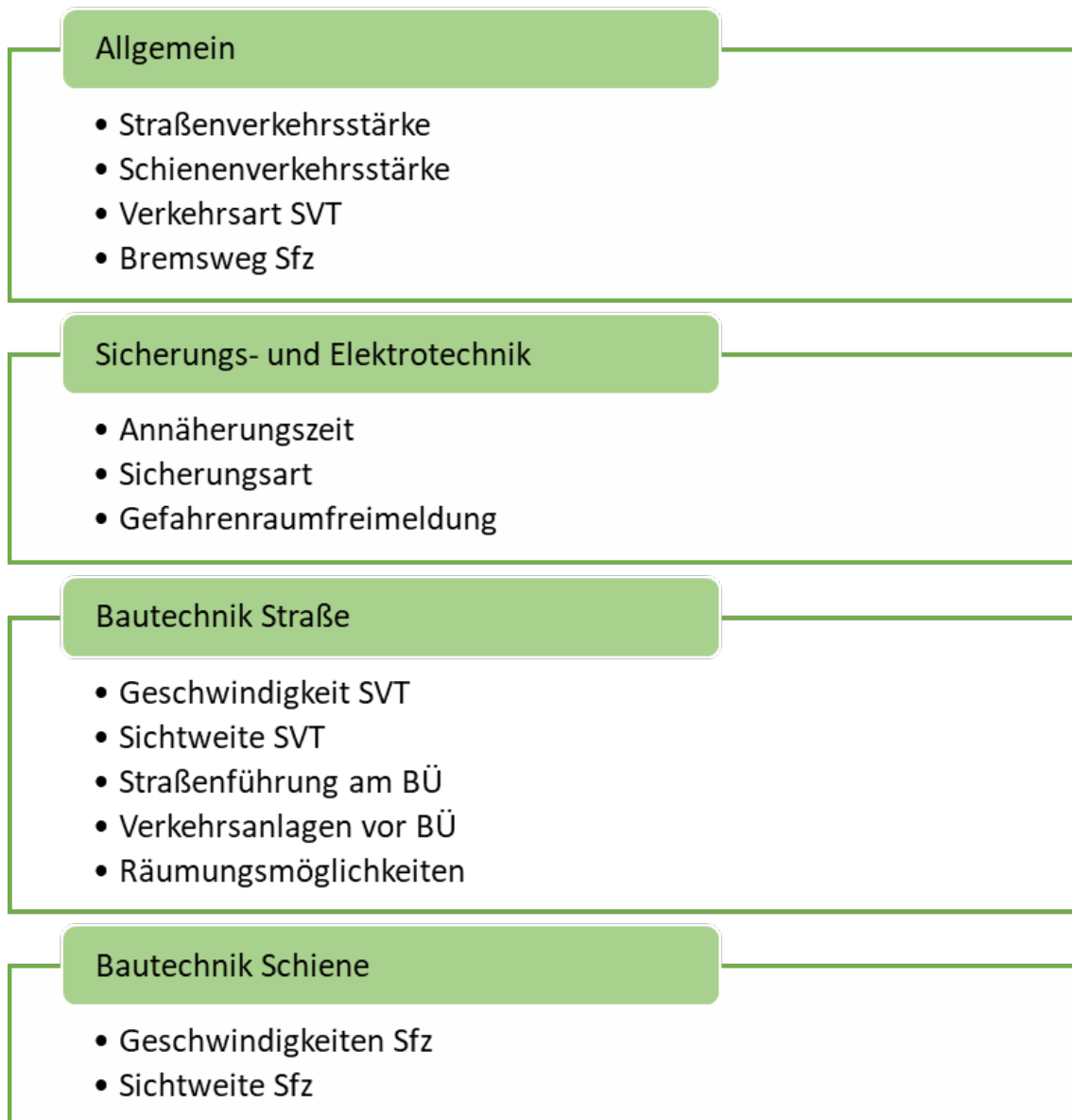
Abbildung 20: Einflussfaktoren auf das Risiko am Bahnübergang nach [9]
