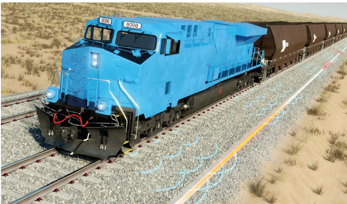
Abbildung 50: Wirkungsweise der akustischen Sensorik [48]
