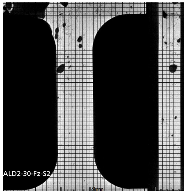
Abbildung 5-95: Schnitte in Breiten- (links) und Dickenrichtung (rechts) aus der CT-Aufnahme der Probe ALD2-30-Fz-S2 mit überlagertem Gitter mit Zellen von 0,5 mm
