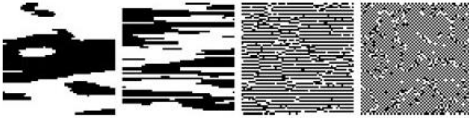
Abbildung 2-4: Realisation von Markov-Feldern mit unterschiedlichen Pore-Pore-Wechselwirkungen
