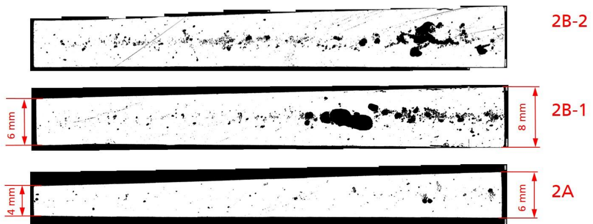
Abbildung 5-70: Visualisierung der Porositätsverteilung in den Schlifffebenen aus Position 2 (vgl. Abbildung 5-69) anhand binarisierter stereomikroskopischer Aufnahmen (Bildmontagen)
