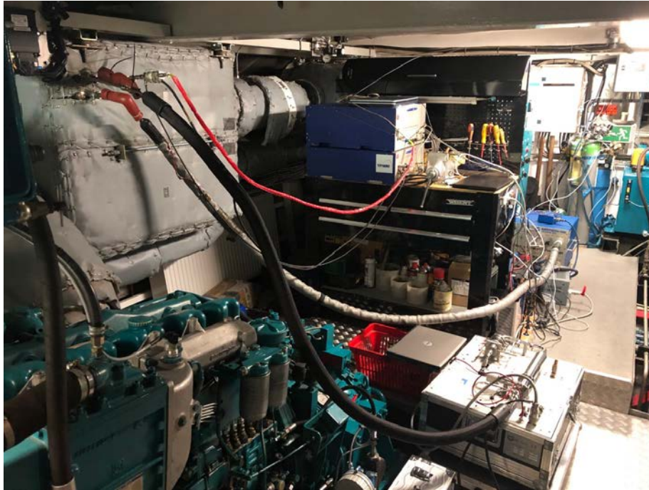
Abbildung 13: Messtechnikanordnung vor der AGN (gasförmig und Partikel/Ruß)
