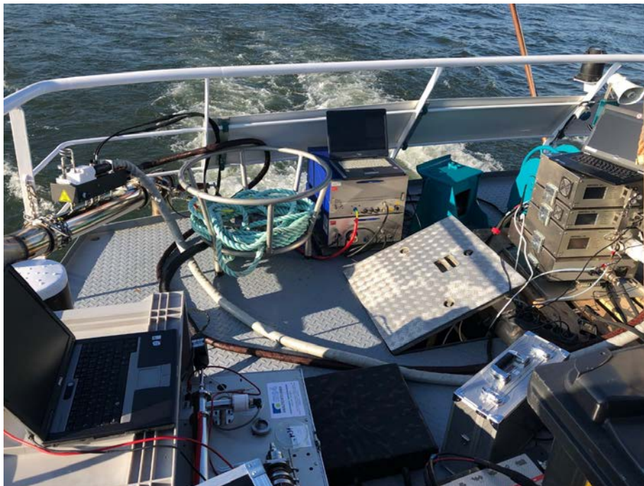
Abbildung 14: Messtechnikanordnung bei Messung nach der AGN („End of pipe“ (Gase, Partikel/Ruß und Abgasmassenstrom))
