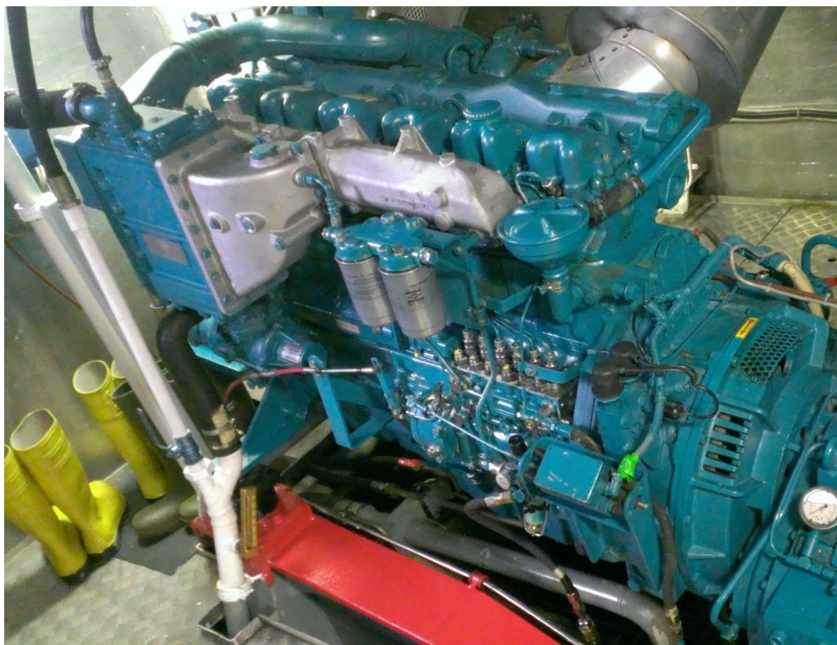
Abbildung 2: Antriebsmotor steuerbordseitig MAN D2866 LXE43
