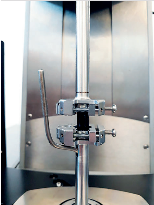
Bild 3-8: Eingespannter Probekörper im Konvektionsofen
