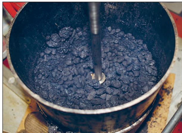
Bild 34: Rührversuch bei einem nicht fließfähigen Gussasphalt
