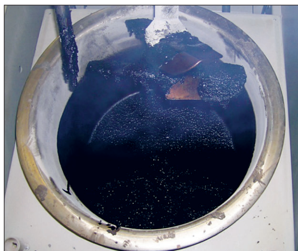
Bild 19: Labormischer zur Herstellung des Gussasphalts
