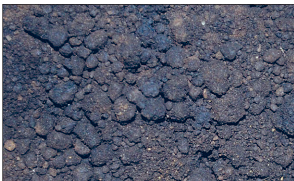
Bild 24: Asphaltmörtel mit zu geringem Bindemittelgehalt bei einem stark versteifenden Füller
