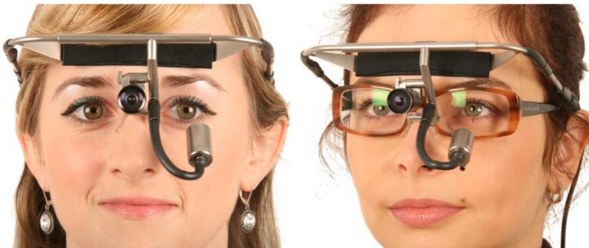
Abbildung 17: Beispielhafte Darstellung des verwendeten Blickbewegungssystem Dikablis bei Probanden mit und ohne Brille. Quelle: Dikablis User Manual (Ergoneers, 2011; S. 20).
