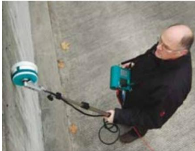
Abbildung 25: Potentialfeldmessung mit Potentialfeldmessgerät
