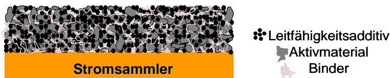
Abbildung 3: Schematischer Aufbau einer Lithium-Ionen-Batterie-Elektrode mit Aktivmaterial, Binder und Leitfähigkeitszusätzen (Quelle: ZBT)
