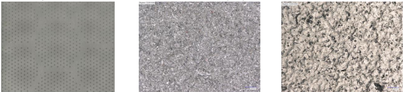
Abbildung 58: Mit und ohne Schablone durch Strahlen strukturierte Edelstahlvorlagen
