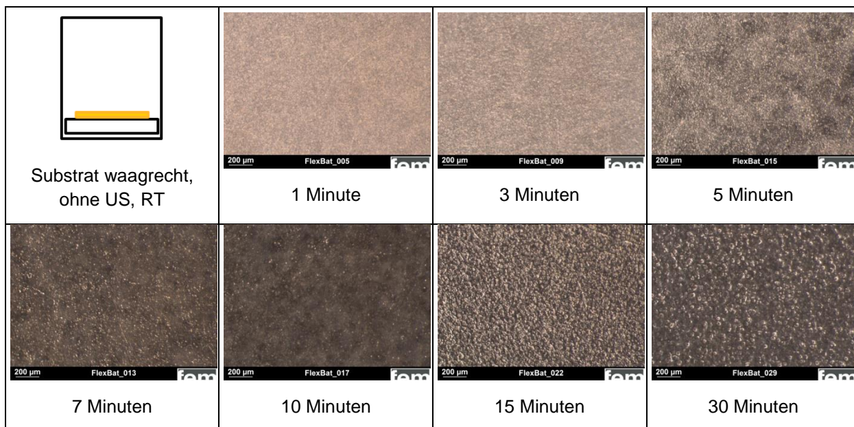
Abbildung 14: Lichtmikroskopische Darstellung des Einflusses der Ätzdauer auf Cu-Proben, welche ohne Ultraschalleinfluss und einer waagerechten Probenposition hergestellt wurden
