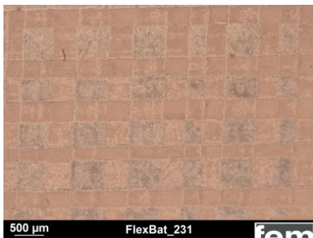
Abbildung 30: Elektrolytisch geätzte Kupferfolie (Probengröße 5 cm x 5 cm, Maske aus wasserfester Tinte, 80 A/dm 2 , 1ms/9ms, 9000 Pulse)
