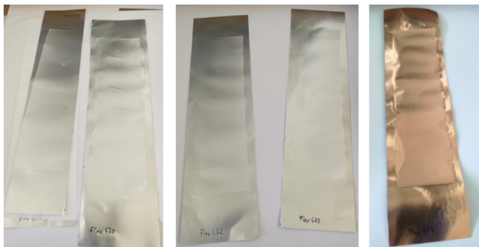
Abbildung 70: Durch Walzprägen strukturierte Al- und Cu-Folien
