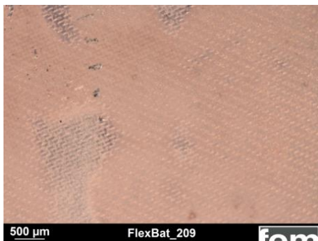
Abbildung 27: Elektrolytisch geätzte Kupferfolie (Polyestermaske, 2000 A/dm 2 , 5ms/95ms, 12000 Pulse)
