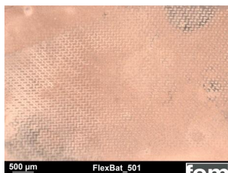
Abbildung 29: Elektrolytisch geätzte Kupferfolie (poröse Kathode, Polyestermaske 400 mesh, 900 A/dm 2 , 1ms/10ms, 12500 Pulse)
