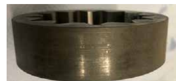
Leichter Abrieb am Außenring des Innenzahnradmotors mit Experimentalfluid (nach 15 h)
