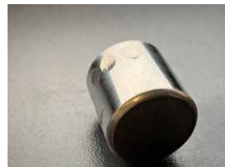
Prüfkörper des Brugger-Tests
