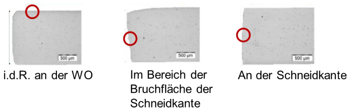
Abbildung 13-60: Schematische Darstellung der Anrissorte für (v. l.) polierte, schergeschnittene und laserstrahlgeschnittene Kante
