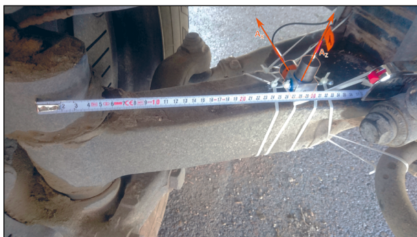
Bild 10: Beschleunigungssensoren auf der rechten Vorderachse
