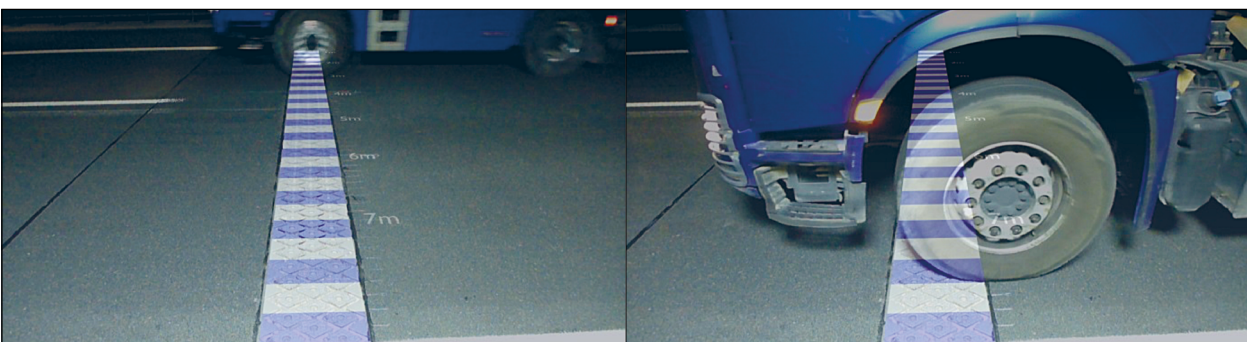
Bild 9: Bestimmung der Überfahrposition und Geschwindigkeit mittels Videoaufzeichnung
