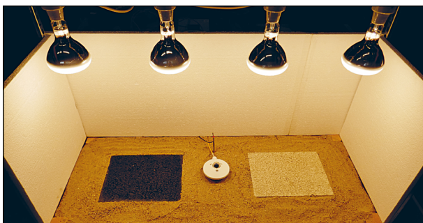
Bild 7-11: Bestrahlungsstand mit zwei unterschiedlichen Asphaltaufbauvarianten und Pyranometer in der Mitte
