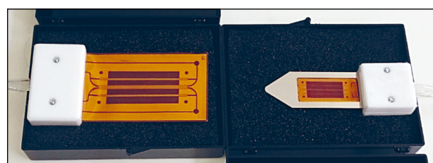
Bild 7-3: Sensoren THB 6N (82 x 42 mm) links und THB6K/MFR (42 x 22 mm) mit Metallrahmen rechts
