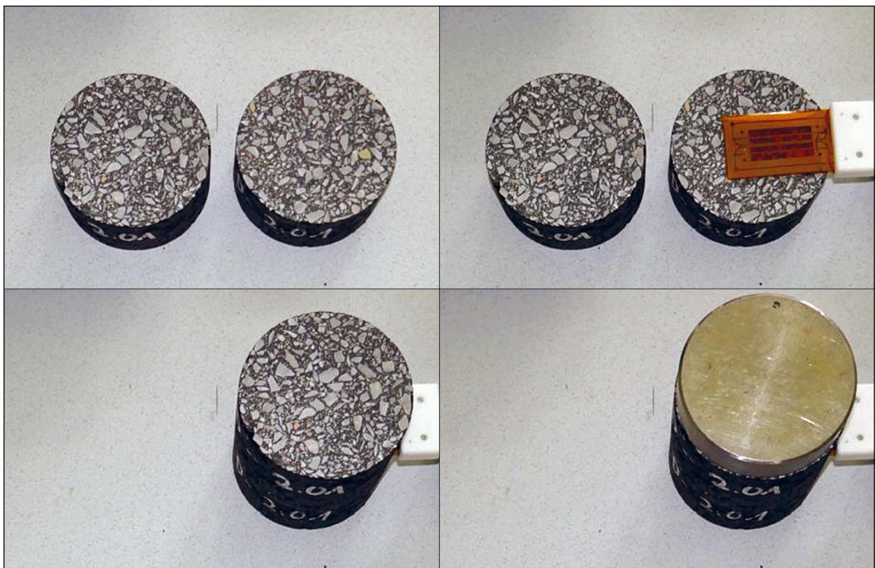
Bild 7-4: MPK SMA-2 mit plangeschliffenen Schnittkreisflächen (o. l.), Platzierung des Messensors auf der Oberfläche (o. r.), Platzierung des Messensors zwischen zwei Marshallprobekörpern (u. l.), Belastung der Probekörper durch Stempel (u. r.)
