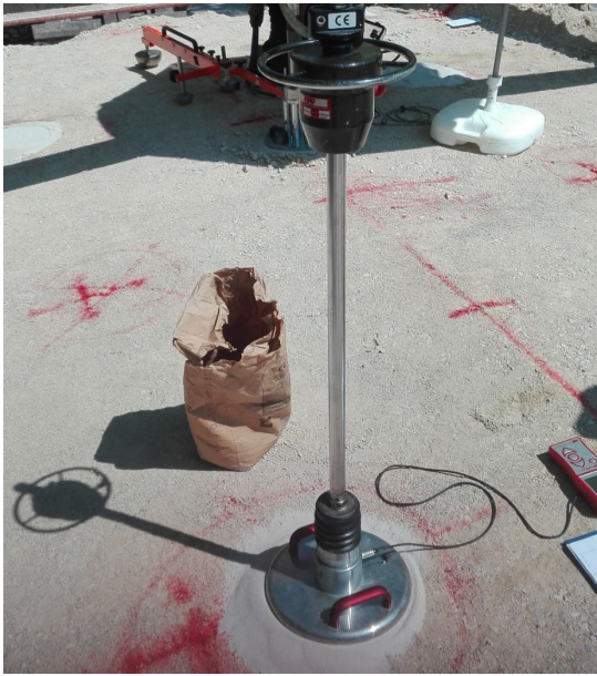
Bild 74: Dynamischer Plattendruckversuch mit Sandkeil auf geneigter Oberfläche in den Feldern 1a und 1b (Foto: Elissavet Barka)
