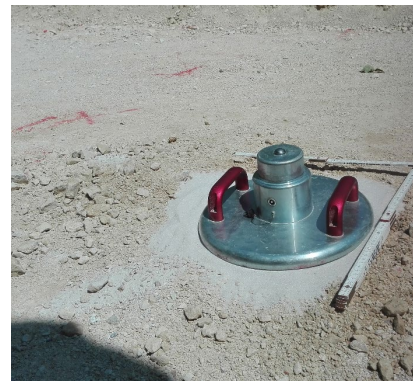
Bild 73: Dynamischer Plattendruckversuch auf Sandausgleichsschicht im Feld 1 (Foto: Christoph Henzinger)
