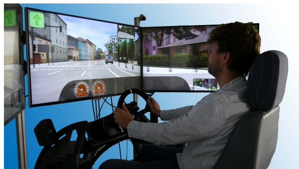
Bild 7: Sichtsystem des Kompaktsimulators mit eingeblendeten Anzeigen, Rückspiegeln und Navigationshinweisen.
