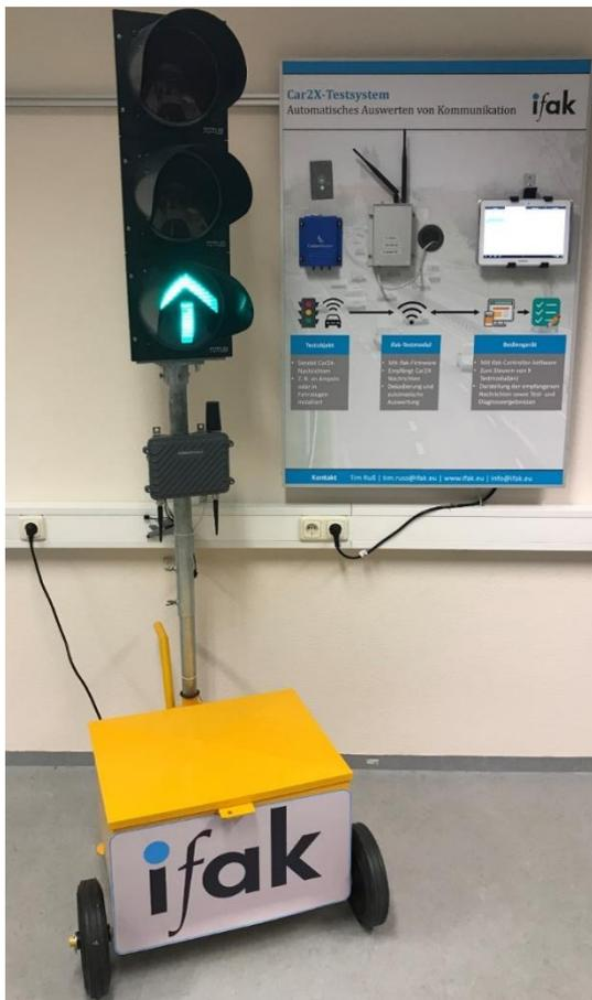
Abbildung 18: Erweiterter Demonstrator zur Diagnose eines V2X-Systems
