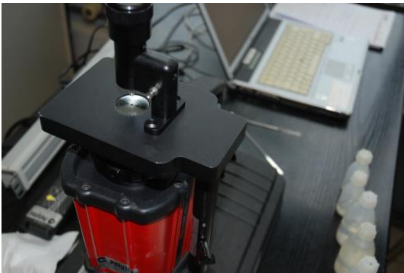
Bild 4-2: IR-Handspektrometer mit ATR-Zelle als Standby Gerät
