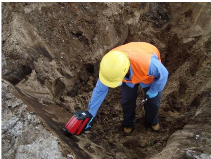
Bild 4-3: IR-Handspektrometer mit ATR-Zelle im Einsatz
