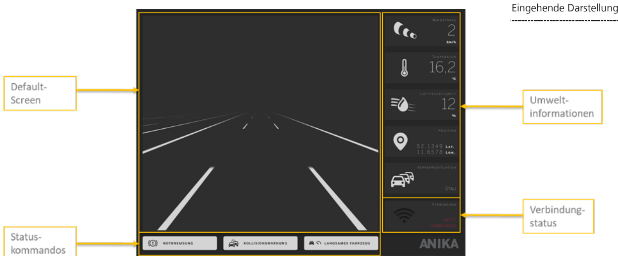
Abbildung 20: Graphische Oberfläche für die Applikation an der Vehicle-ITS-Station.
